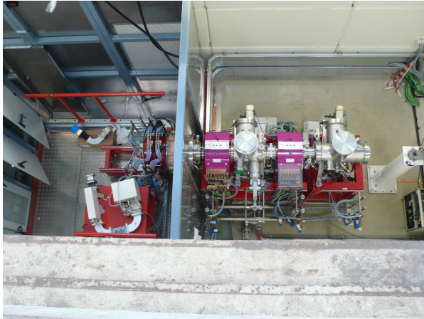
Figure: The IFMIF LEBT (top view).
