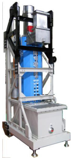
Actual Toshiba klystron
